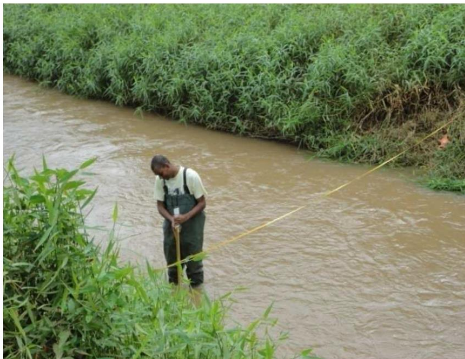
Figura 22 - Medição de vazão com molinete hidrométrico (ARAUJO, 2013).
